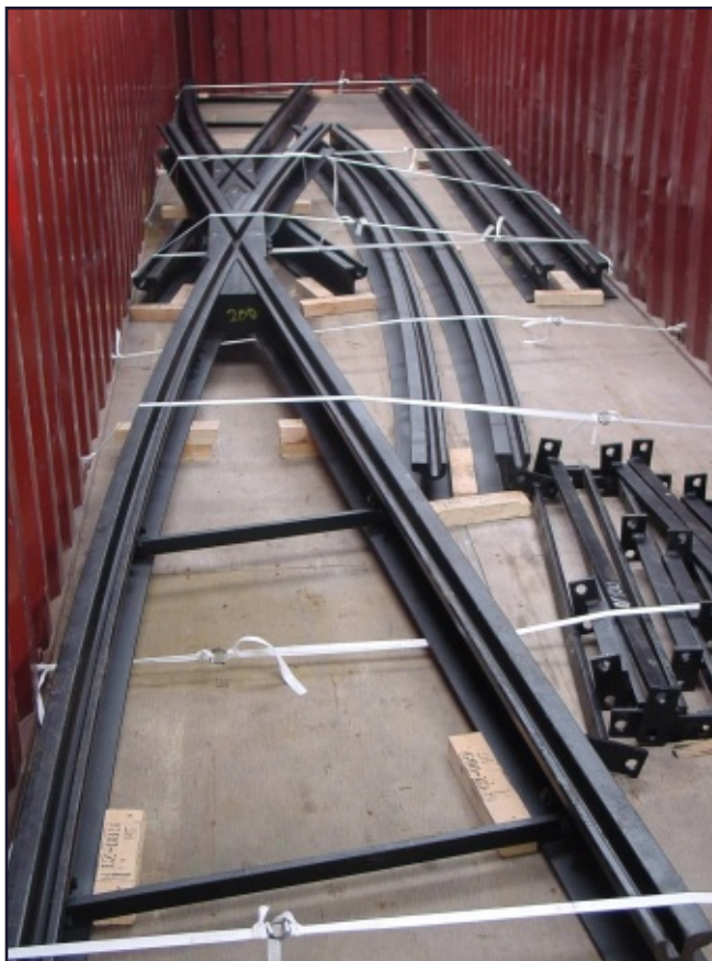
Tramvajová výhybka v kontejneru
