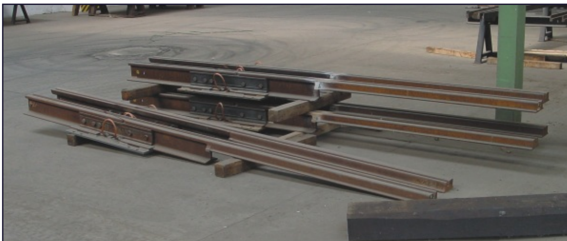
Přechodové kolejnice s vloženou dilatační kolejnicí
