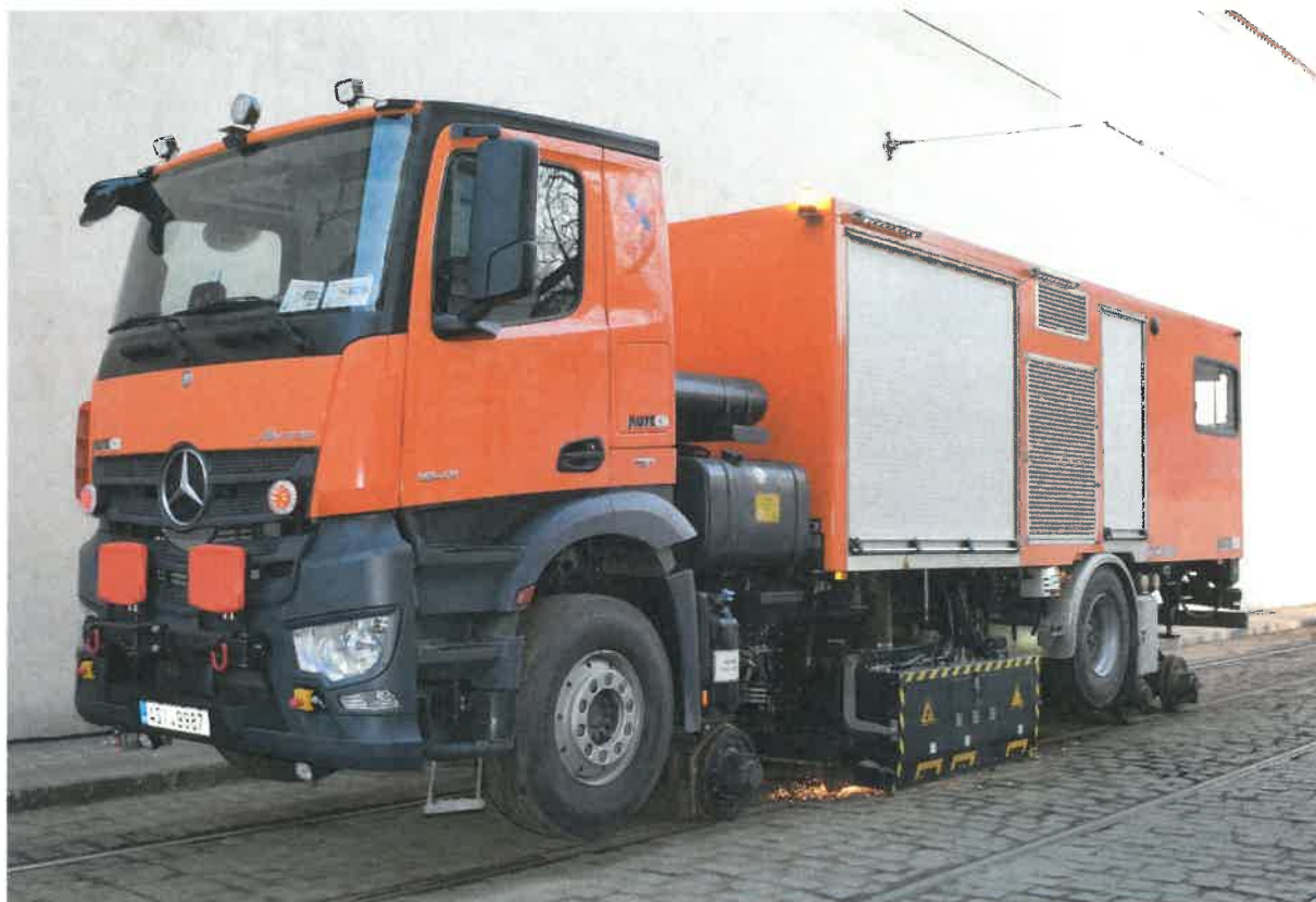
Obrázek č. 4: Brusný stroj AT2200-12E
