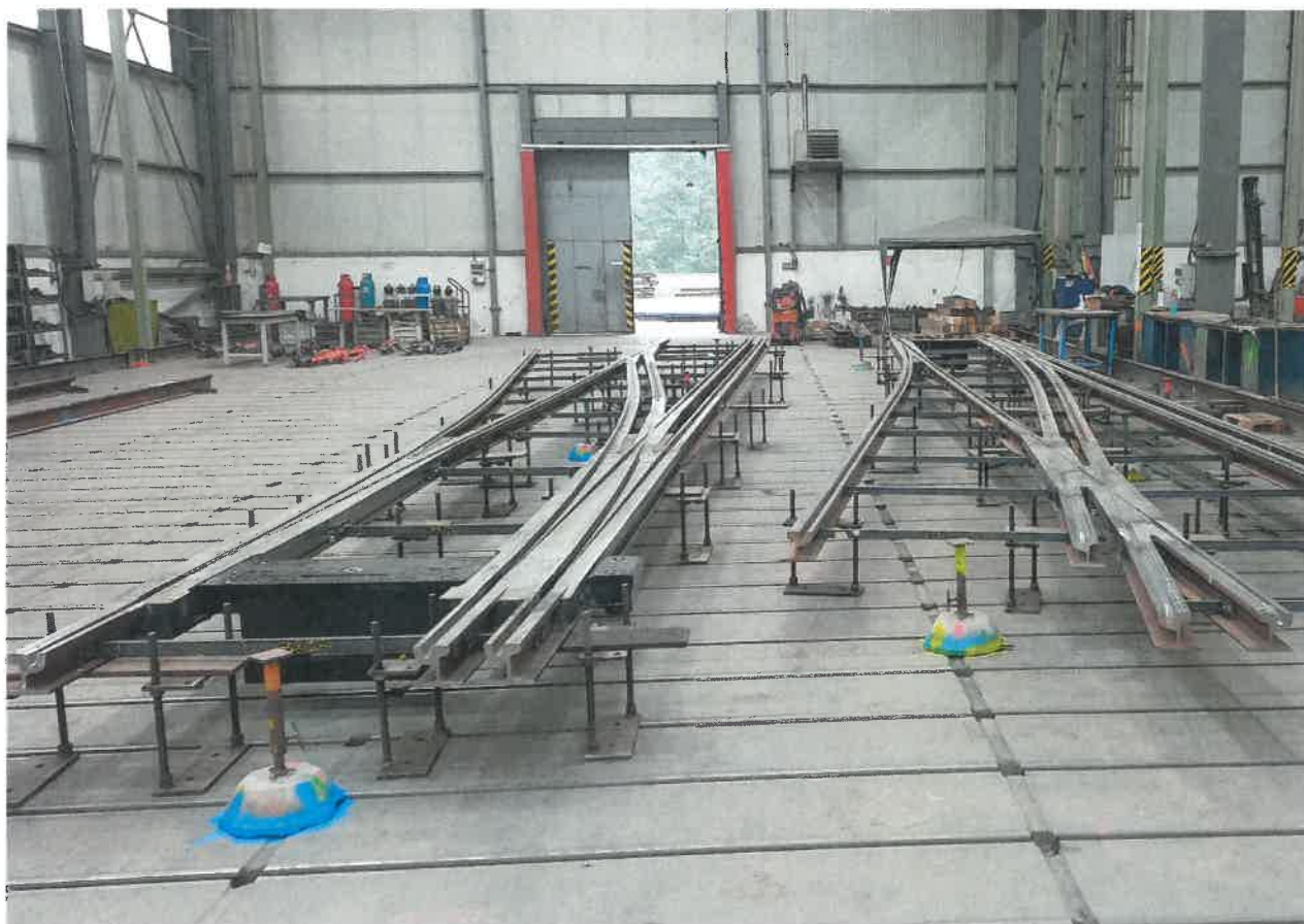
Obrázek č. 2: Čepová dvojjýměna ve výhybce
