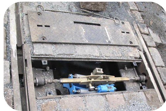
sjezdový výhybkový systém VS-20
