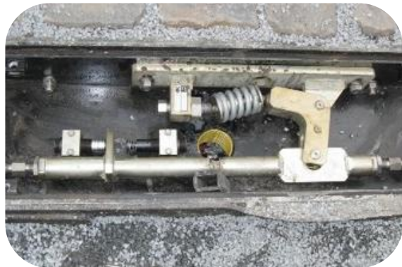
sjezdový výhybkový systém VS-21
