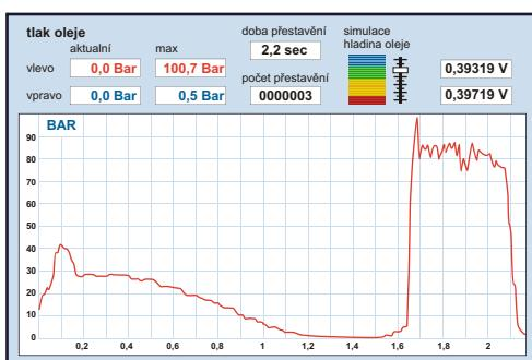
Veškeré diagnostické informace lze přenášet do centrálního řídícího systému a zobrazovat je ve formě statistických a alarmových hlášení.
