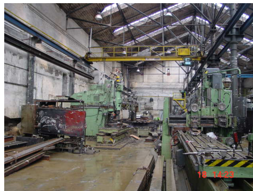
Interiér výrobní haly po opadnutí povodňové vlny v srpnu 2002
