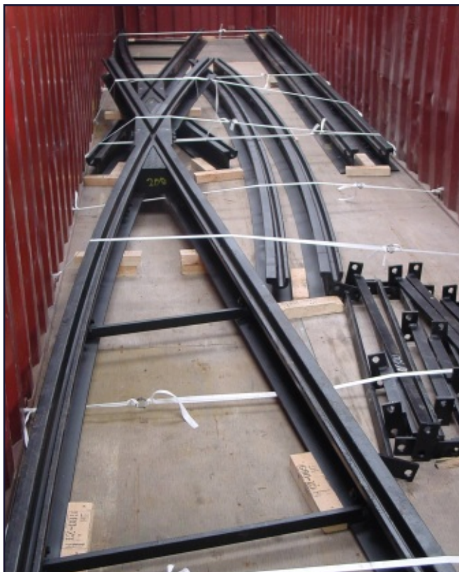
Straßenbahnweiche im Container
