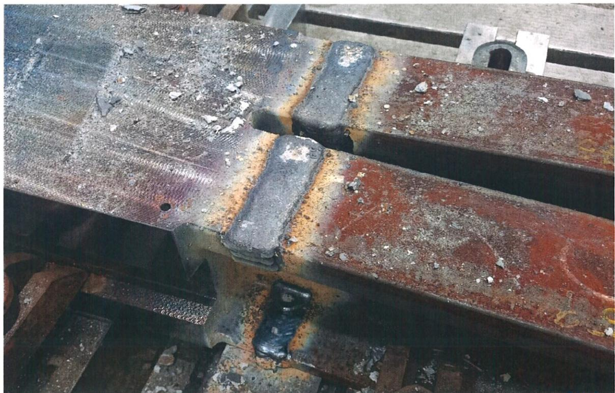
Obrázek 4: Zkouška přivaření klepet na reprofilace na vzorku
