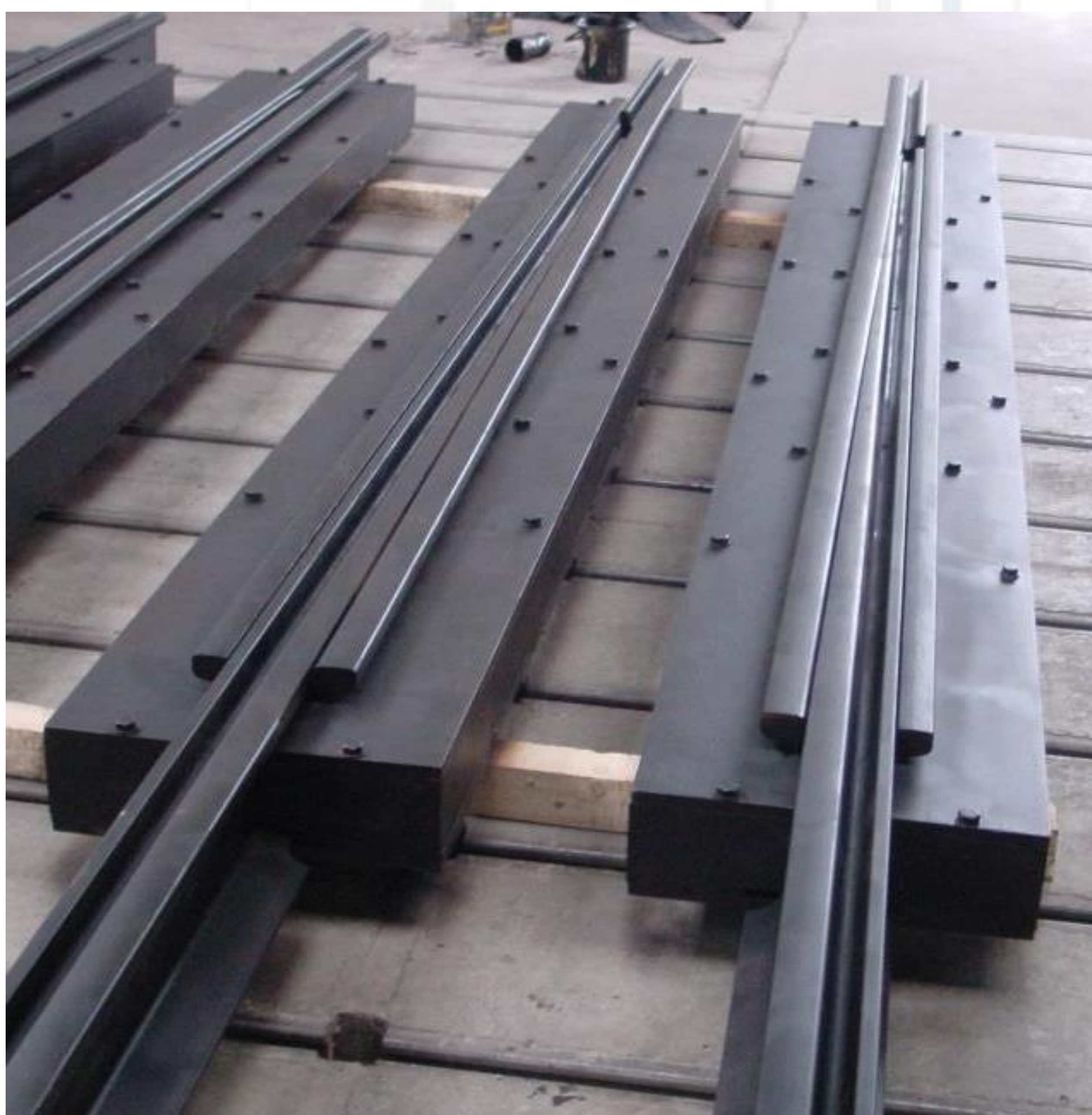
Mostní dilatační zařízení
